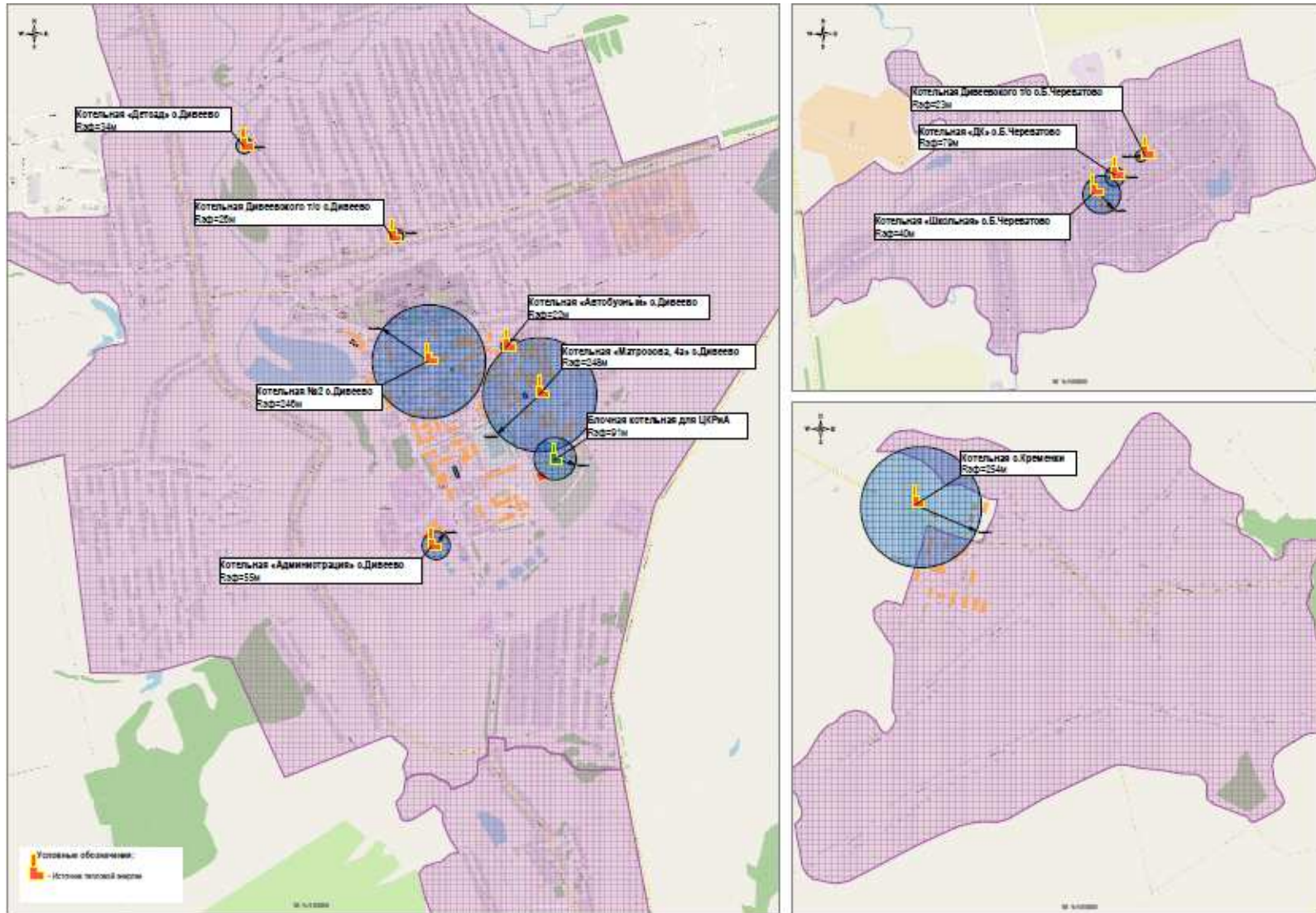
Рис. 2.17. Схема существующих радиусов эффективного теплоснабжения от котельной «Школьная» с. Б.Череватово, котельной «ДК» с. Б.Череватово, котельной Дивеевского территориального отдела в с. Б.Череватово, котельной «Детский сад» с. Дивеево, котельной «Автобусный» с. Дивеево, котельной Дивеевского территориального отдела в с. Дивеево, котельной №2 с. Дивеево, котельной №1 с. Дивеево, котельной «Администрация» с. Дивеево и котельной с. Кременки.
