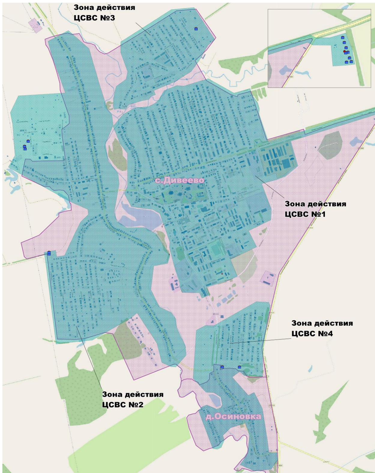
Рис. 1.1. Зоны централизованных систем водоснабжения №1-№4 (с.Дивеево и д.Осиновка)
