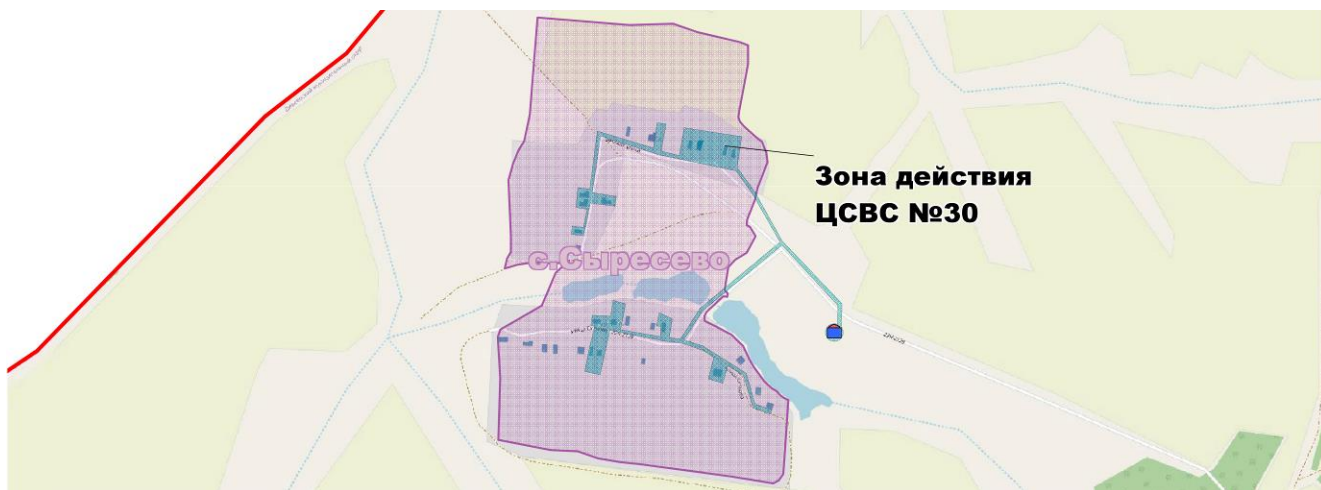
Рис. 1.25. Зона централизованной системы водоснабжения №30 (с.Сыреево)
