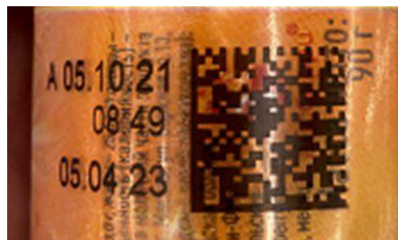
Печать кода маркировки на бликующей/светоотражающей поверхности
